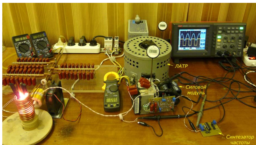
Рис.14. Инвертор в процессе испытаний
