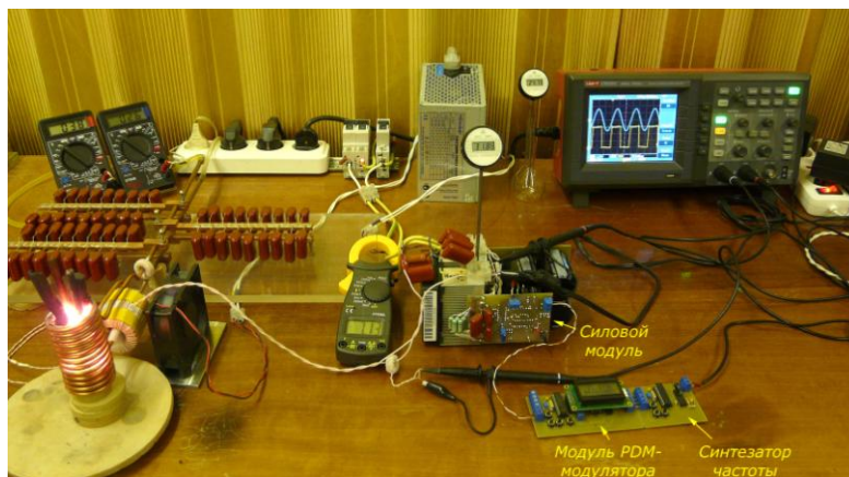
Рис.22. Инвертор с PDM-регулировкой мощности в процессе работы
