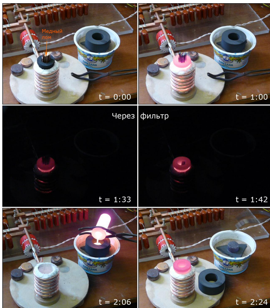
Рис.14. Плавка меди в графитовом тигле. Моменты времени (мин:сек) в правом нижнем углу каждого кадра
