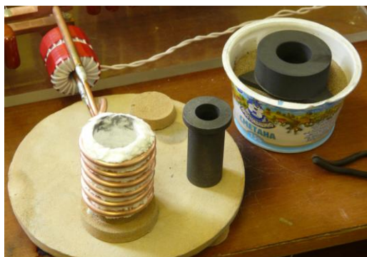
Рис.14. Подготовка к тигельной плавке
