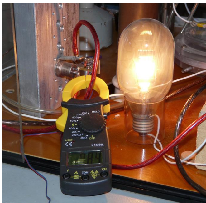
Рис.2 Собранный регулятор в процессе испытания
